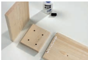
Wasserdichter Leim gibt den zu verbindenden Teilen zusätzlichen Halt.
