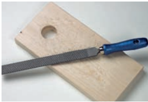
Werden gehobelte Bretter verwendet, muss die Innenseite der Vorderwand mit einer Raspel angeraut werden.
