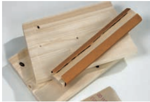
Unregelmäßigkeiten der Sägekanten mit Schleifpapier und einem Stück Latte als Schleifklotz glätten.
