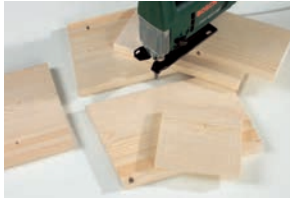
Mit einer elektrischen Stichsäge exakt aussägen.
