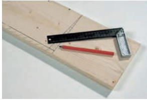
Die benötigten Einzelteile mithilfe eines Winkels anzeichnen.
